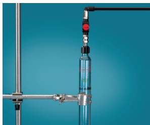
● Sample chamber Injection unit과 함께 100ml까지 시료 주입시 사용
