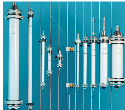
● Multiple Column Valves 크로마토그래피 시스템에서 6개의 다양한 조건을 연속적으로 구동가능함
