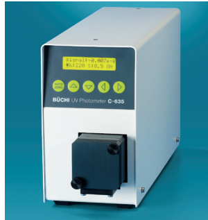
● C-635 UV Photometer 190~730nm의 전파장에서 측정 가능한 detector
